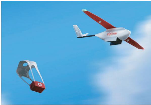
図5 無人航空機（UAV）が目的地に血液が梱包された積荷をパラシュート投下する風景 ジップライン社製（同社HPから）。
