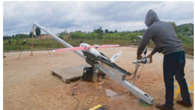
図4 無人航空機(UAV)の発射風景 ジップライン社製(筆者撮影)。
