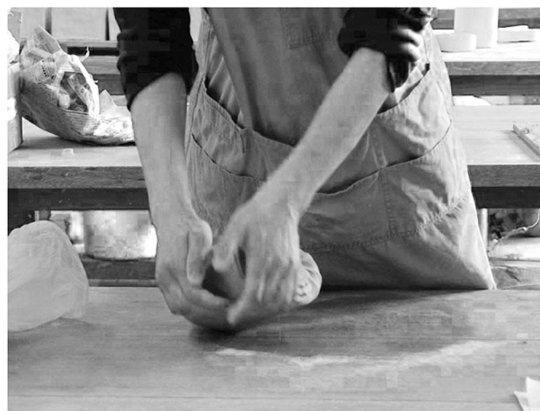
図2 土練りの様子 重たく堅い粘土を手早く練らなければならない。
