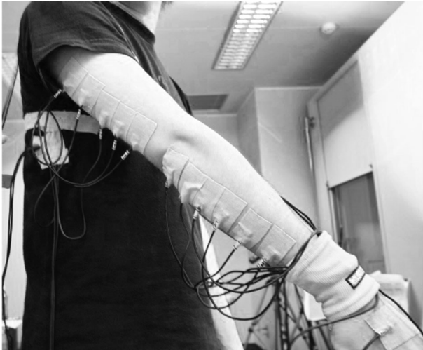
図4 加速度センサアレーを使って腕の柔軟性を調べるところ
