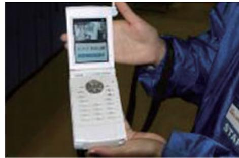
図5 ワンセグの試作端末 (NHK 技研公開 2003)
