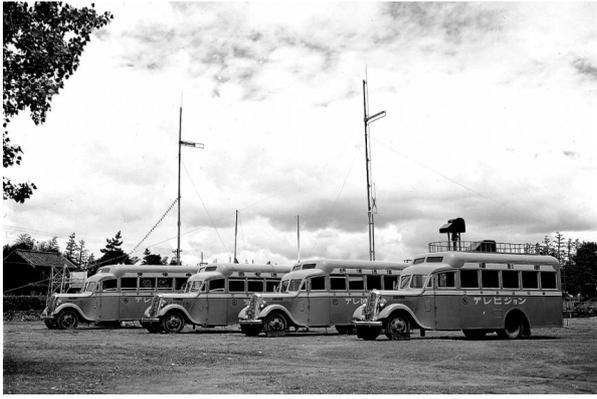
図1 テレビ自動車と呼ばれた中継車 後方左から受信車，音声送信車，映像送信車，撮像車。
