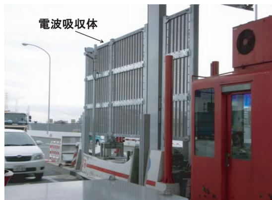
図 1 ETC レーン間干渉抑圧用格子形電波吸収体
