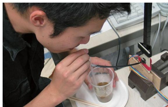
図1 吸飲感覚を記録している様子 ストローにセンサを取り付け、吸飲時に生じる触覚情報を記録した。
