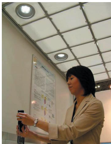
図1 可視光通信と携帯電話によるインターネットアクセスの組合せによる屋内位置検出 (NEC, 松下電工, 慶大の試作)
