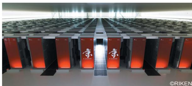
図 1 分散メモリ型スーパーコンピュータ「京」
