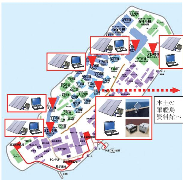
図2 軍艦島モニタリングシステム 島内で最も高所にある3号館の屋上と本土の軍艦島資料館を海上無線通信で結ぶ。各建物に、太陽光発電パネル、蓄電池、カメラ、マイクロホン、加速度センサ等を設置。
