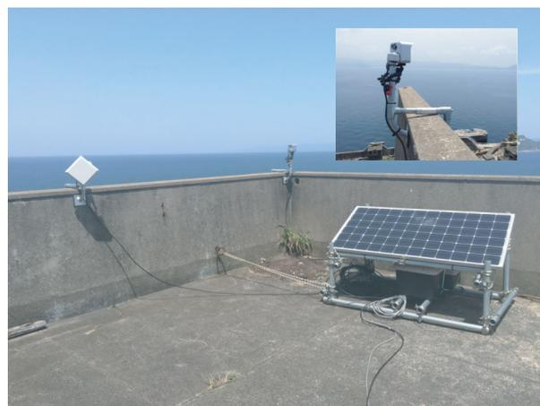
図3 3号棟屋上に設置した太陽光発電パネル・蓄電池、通信アンテナ、カメラ 本土側の軍艦島資料館にも同様の通信アンテナを設置し、海洋上無線通信を確保。
