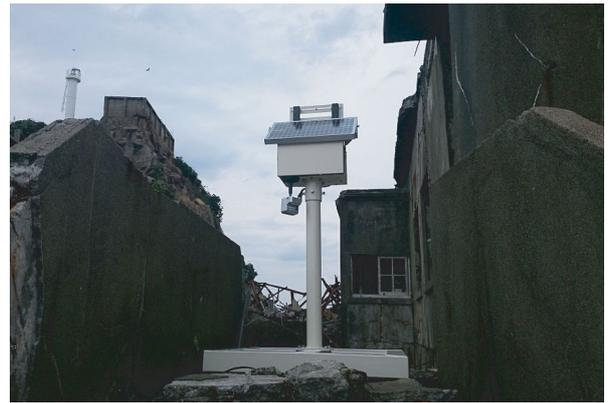
図6 30号棟前に設置した自律画像センシングシステム
