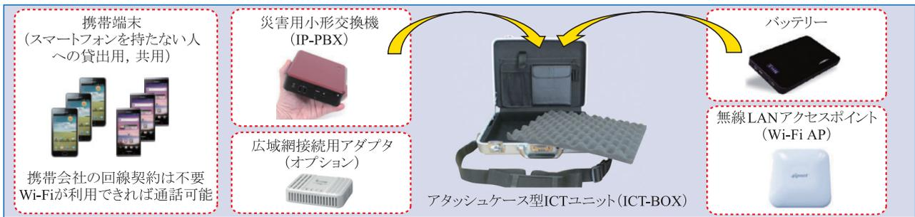
持ち運びサイズのキャリーケースに必要な機材を詰め、被災地に移動することで、最低限の連絡手段を即時に提供することが可能。
