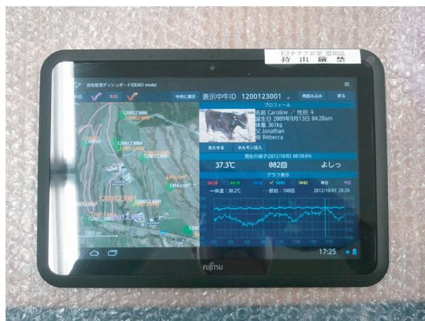
図4 放牧牛のモニタリングシステムのプロトタイプ
