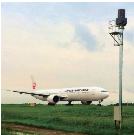
図8 成田空港にて実証実験中の滑走路監視レーダ
