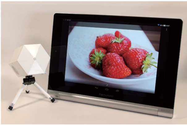
図2 香り噴射装置の外観（写真左側） 画像の切替時などで瞬時に6種類の香りを入れ替えることができる。
