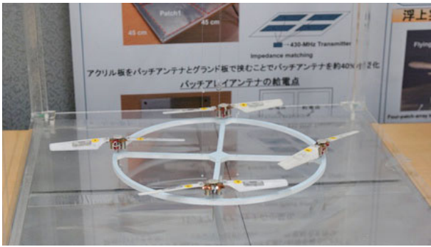
図3 3Dプリンタで自作したドローンによる給電飛行 (7)
