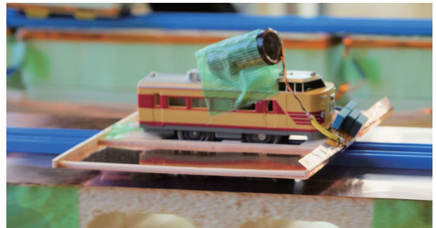
図7 超軽量ワイヤレス給電システムを搭載したプラ電車 (16)
