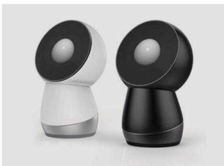
図 2 家庭用ロボット「Jibo」 高さ約 28 cm, 質量約 2.7 kg. メッセージ読み上げや写真撮影の機能を持つ。体をくねらせる動きが特徴的だった。（出典：KDDI）
