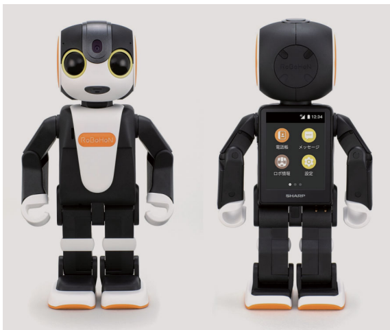
図5 モバイル型ロボット「RoBoHoN」 現行モデルの2足歩行タイプ。高さ約19.8 cm，質量約395 g。OSはAndroid 8.1，自由度は13軸。背面に2.6型ディスプレイを備える。（出典：シャープ）
