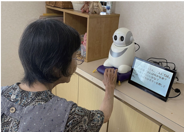
図7 高齢者の見守りサービス「みまもり パペロ」 ロボット型ユーザインタフェース「PaPeRo i (パペロアイ)」を使う。高さ30 cm, 質量約 2 kg. 座布団に座った姿が印象的だ。(出典: NEC)
