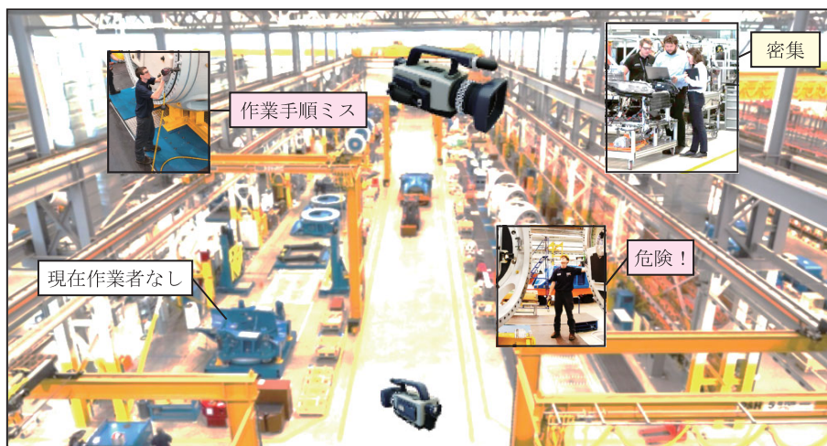
図1 工場での高精細映像・映像 AI 解析の利用例 多数のカメラ映像を AI 解析して工場ラインの作業員のモニタリングを行う。
