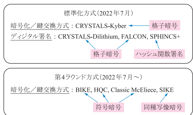
図4 NIST PQC 標準化方式と第4ラウンド方式 (2022年7月)
