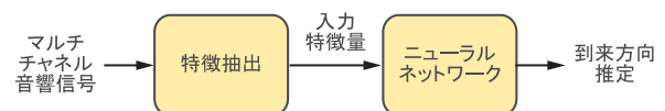
図1 深層学習に基づく音源定位システムの基本構成 “A Survey of Sound Source Localization with Deep Learning Methods” (1) の図1を参考に著者が作成。マルチチャンネル音響信号から抽出した入力特徴量をニューラルネットワークで処理して到来方向を推定する。
