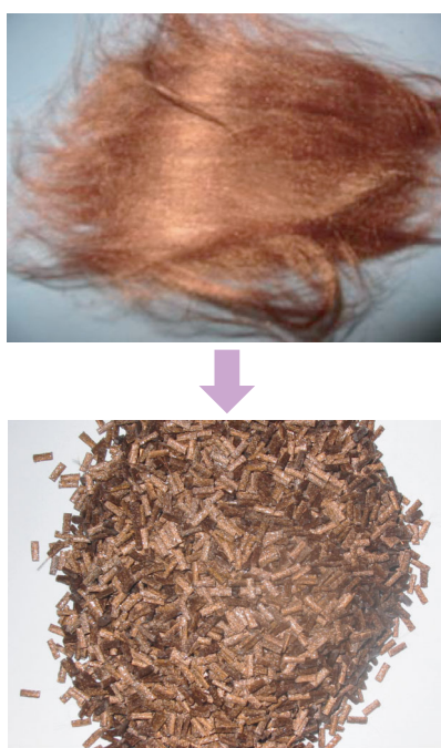
図1 めっき繊維のマスターバッチ化 銅めっきした細線状繊維を樹脂で固め3~10mmで裁断したもの(マスターバッチ)。
