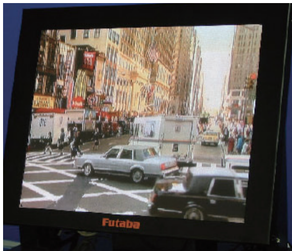
図5 回転蒸着法エミッタを用いた14.4インチFED
