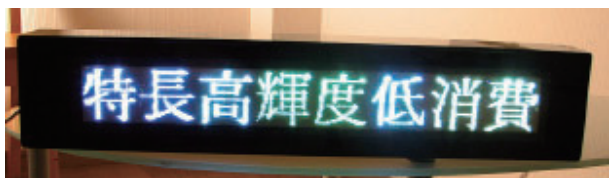
図6 高解像度キャラクタディスプレイ用 CNTFED ピクセルピッチ：1.8mm，ディスプレイエリア：57.6mm×460.8mm.
