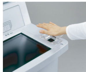
図1 手のひら静脈センサ内蔵ATM
