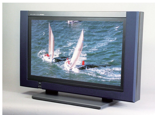
図 5 PDP によるハイビジョン受像機「長野モデル」(1998) 42 インチ PDP (プラズマディスプレイ) を用いて、垂直方向に 1,000 以上の表示セルを実現した初のテレビ受像機。長野冬季オリンピックの際に全国各地でハイビジョン放送を公開展示した。後のテレビディスプレイの薄形大画面化・高精細化の先駆けとなった。
