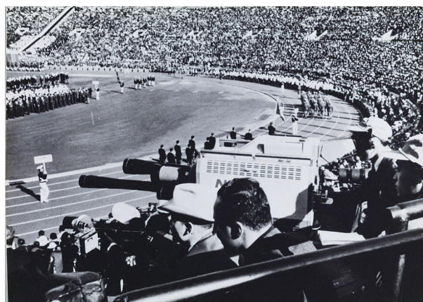
図3 東京オリンピック開会式を撮像する分離輝度式カメラ（1964） 当時の撮像管の課題を改善するため、輝度用と色度用の2本の撮像管を用いる方式で開発されたカメラ。東京オリンピックの開会式の中継に使用された。
