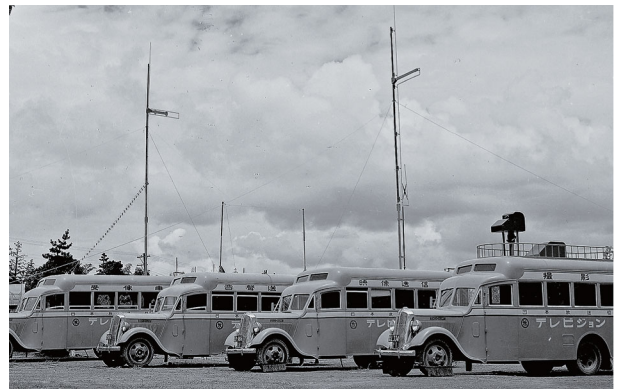
図2 幻の東京オリンピックに向けて開発された中継車(1937) テレビ自動車と呼ばれた中継車群。後方左から受像車、音声送信車、映像送信車、撮影車の4台で1組。
