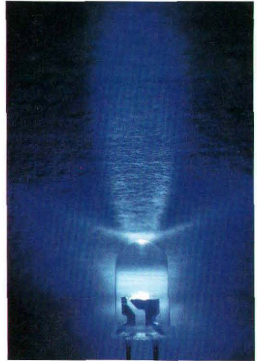
図4 実際に発光している状態の InGaIn/AlGaIn 青色 LED
