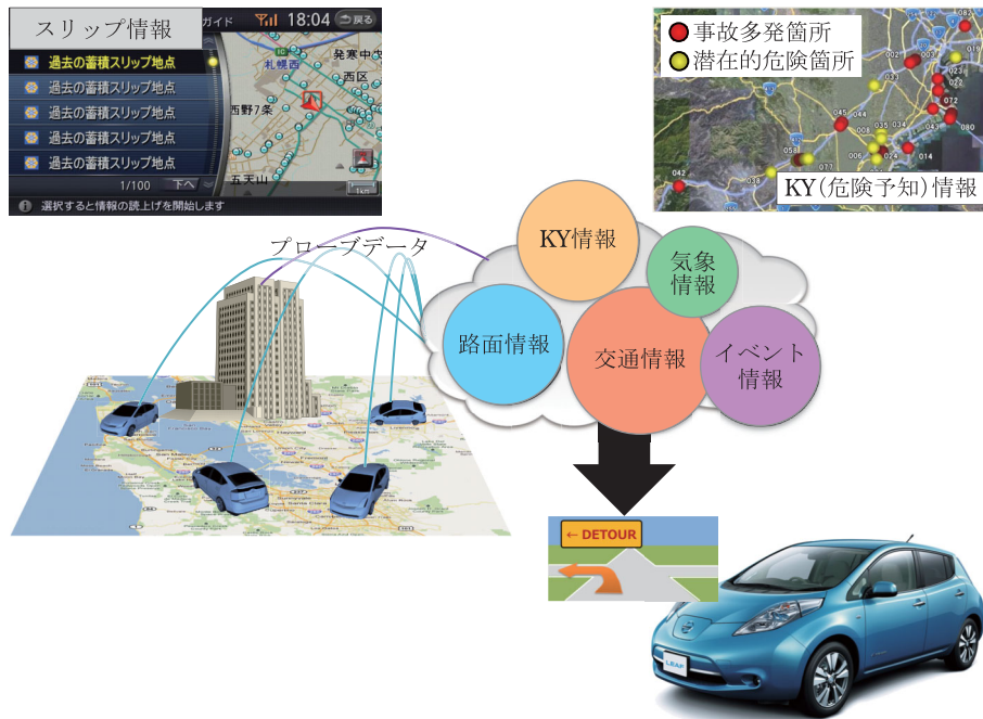
図5 自動運転システムとクラウドシステムのネットワーク化 関連するリアルタイム情報やプローブデータを利用した履歴情報を活用、安全で効率の良い移動を実現する。
