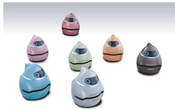
図7 ロボットカー EPORO 魚群行動を模倣するために相互通信にてネットワーク化、周囲環境に柔軟に対応した安全で効率の良い群走行制御の検証を実施した。
